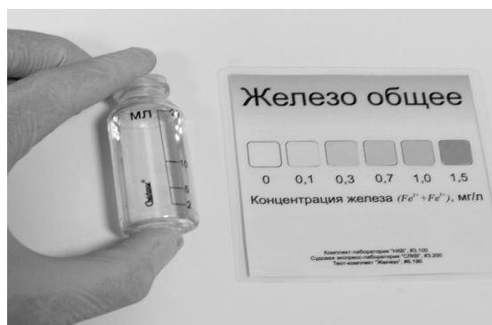
Рисунок 3 – Концентрация железа общего в доочищенной водопроводной воде (ПДК=0,3 мг/л)
